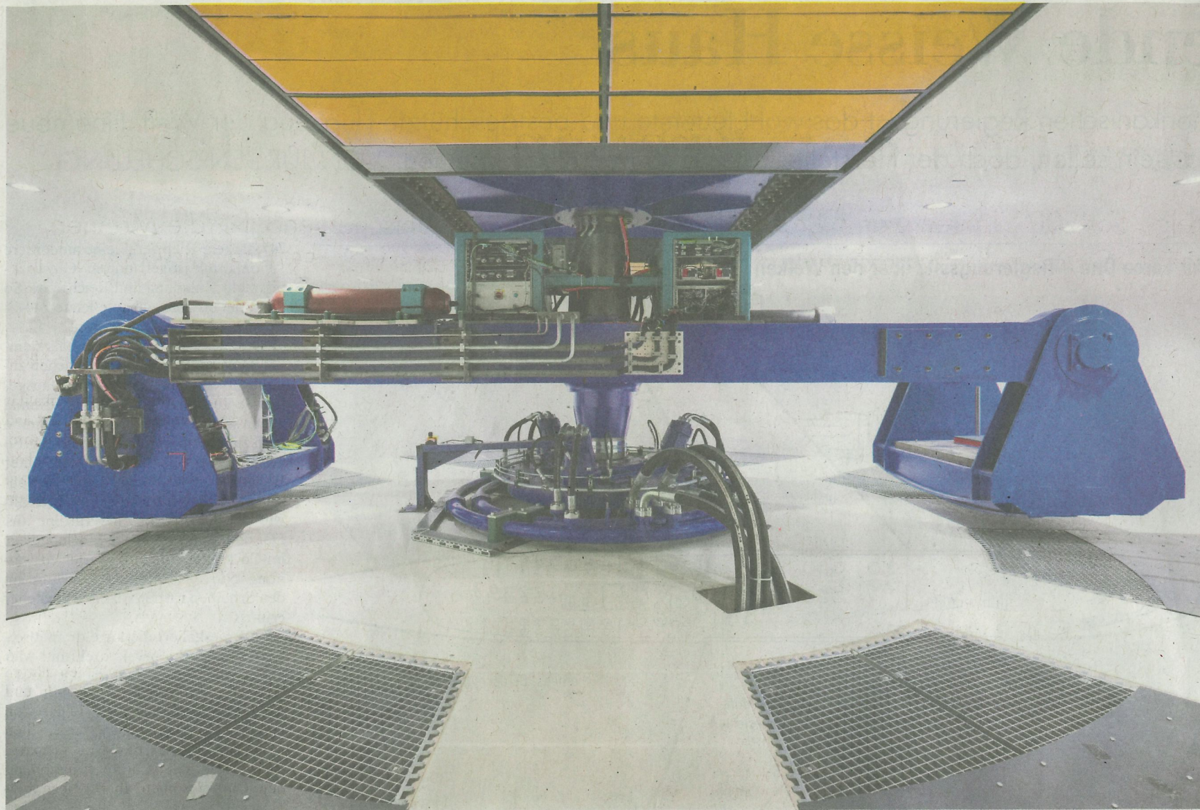
Die Zentrifuge besteht aus massivem Stahl, denn sie muss extremen Kräften widerstehen.
